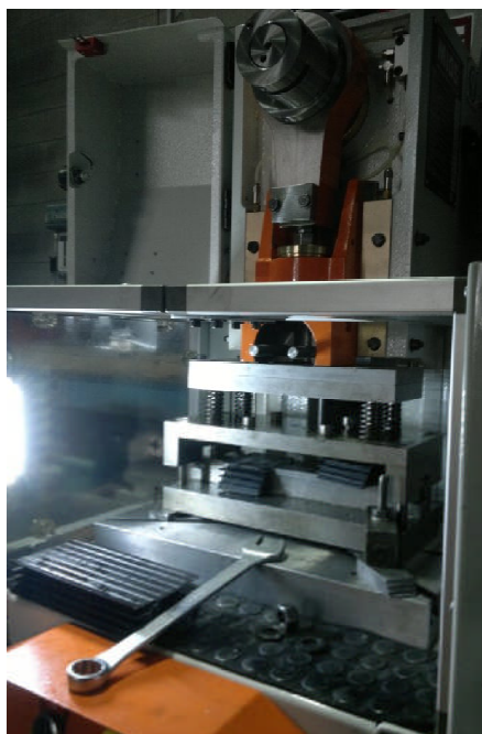
FOTO DI ESEMPIO: SI ESEGUONO OPERAZIONI DI TRINCIATURA SU PROFILI ESTRUSI IN ALLUMINIO
